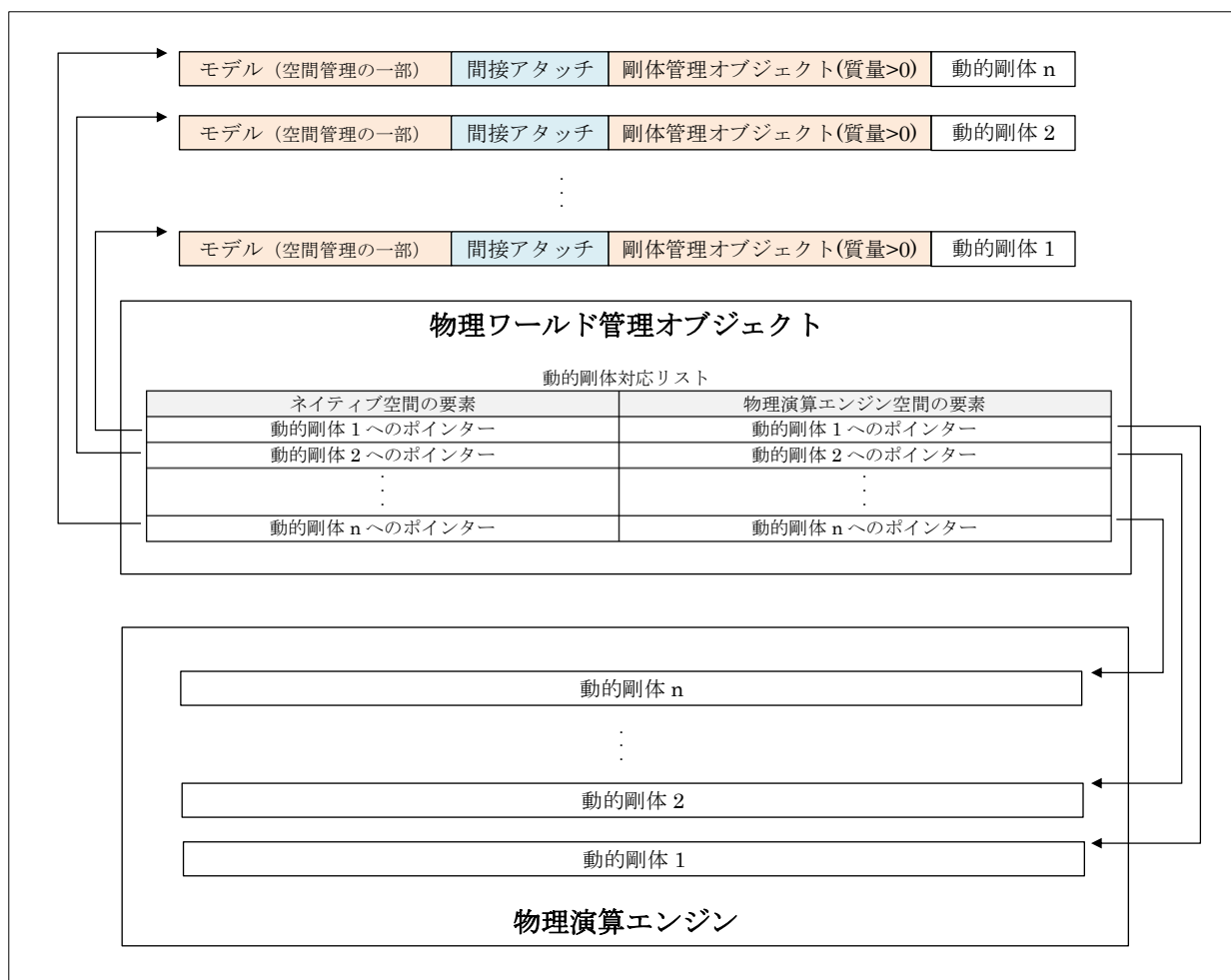
図 7-11 物理ワールドの動的剛体と物理エンジン ワールドの動的剛体の関連
