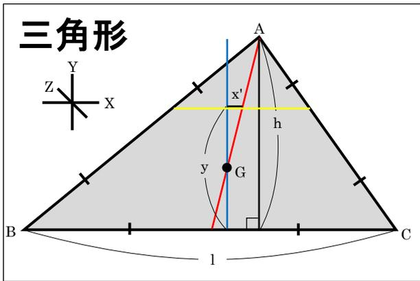
面密度を  $\rho = \frac{M}{lh\frac{1}{2}} = \frac{2M}{lh}$ 、重心を通る Y 軸と平行なベクトルに対する G から A へのベクトルの傾きを  $GA_{incl} = \frac{A_x - G_x}{A_y - G_y}$ 、三角形の高さ y における重心を通る Y 軸と平行なベクトルと G から A へのベクトルの X 軸方向の距離を  $x' = GA_{incl}y - GA_{incl}\frac{h}{3} = GA_{incl}\left(y - \frac{h}{3}\right)$  とすると、
